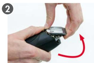
So nehmen Sie den Schneidsatz Ihrer Max45 oder Max50 ganz einfach ab: Schalten Sie das Gerät zuerst aus und ziehen Sie den Stecker. Drücken Sie dann die Schnellwechsel-Drucktaste vorne an der Rückseite der Maschine. (Abb. 1) Halten Sie die Schnellwechsel-Drucktaste gedrückt. Drücken Sie den Schneidsatz mit der anderen Hand am Scherkamm vorne leicht nach oben. (Abb. 2)
